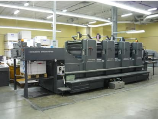
A FOUR-COLOR OFFSET PRESS ONE UNIT PER INK Rémi · Heidelberg Speedmaster Press IGN · 2010 · Rémi, CC BY-SA 3.0, via Wikimedia Commons
